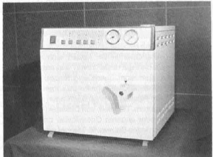
Gerät für die Heißluftsterilisation chirurgischer Instrumente
