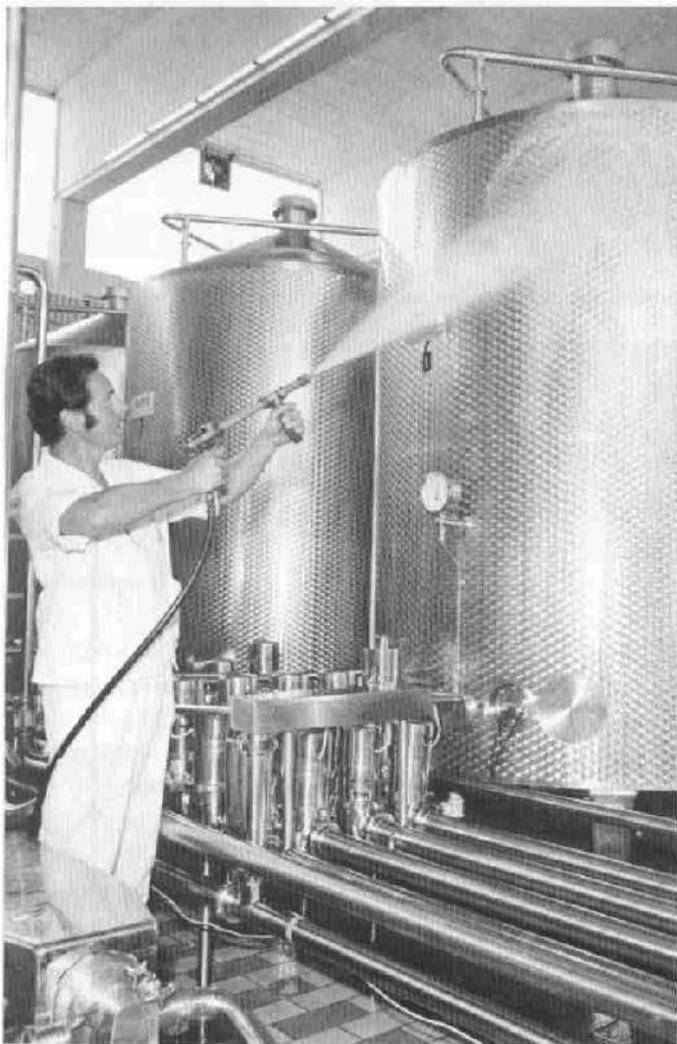
Hochdruckreinigung von Edelstahltanks
